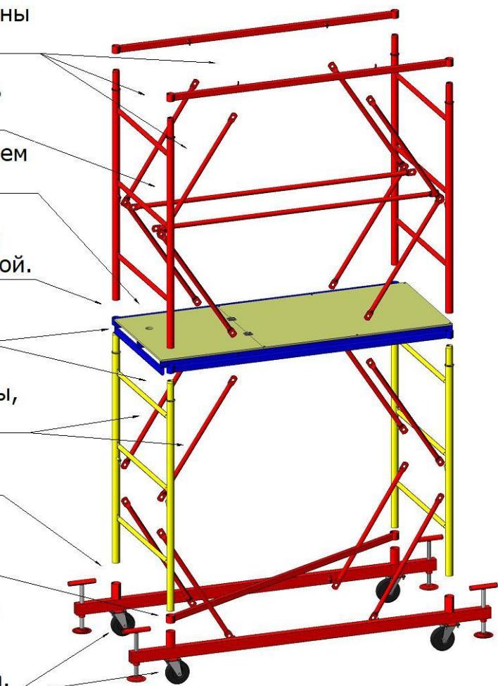
При сборке вышки высотой более четырёх секций, у основания необходимо установить и закрепить стабилизаторы (не входят в комплект поставки) для дополнительной устойчивости.
